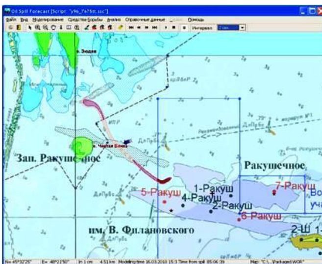
Рис. 2.7 Модель эволюции нефтяного разлива на месторождении им. Филановского в северной части Каспийского моря на 28 часов (вверху) и 85 часов (внизу).
